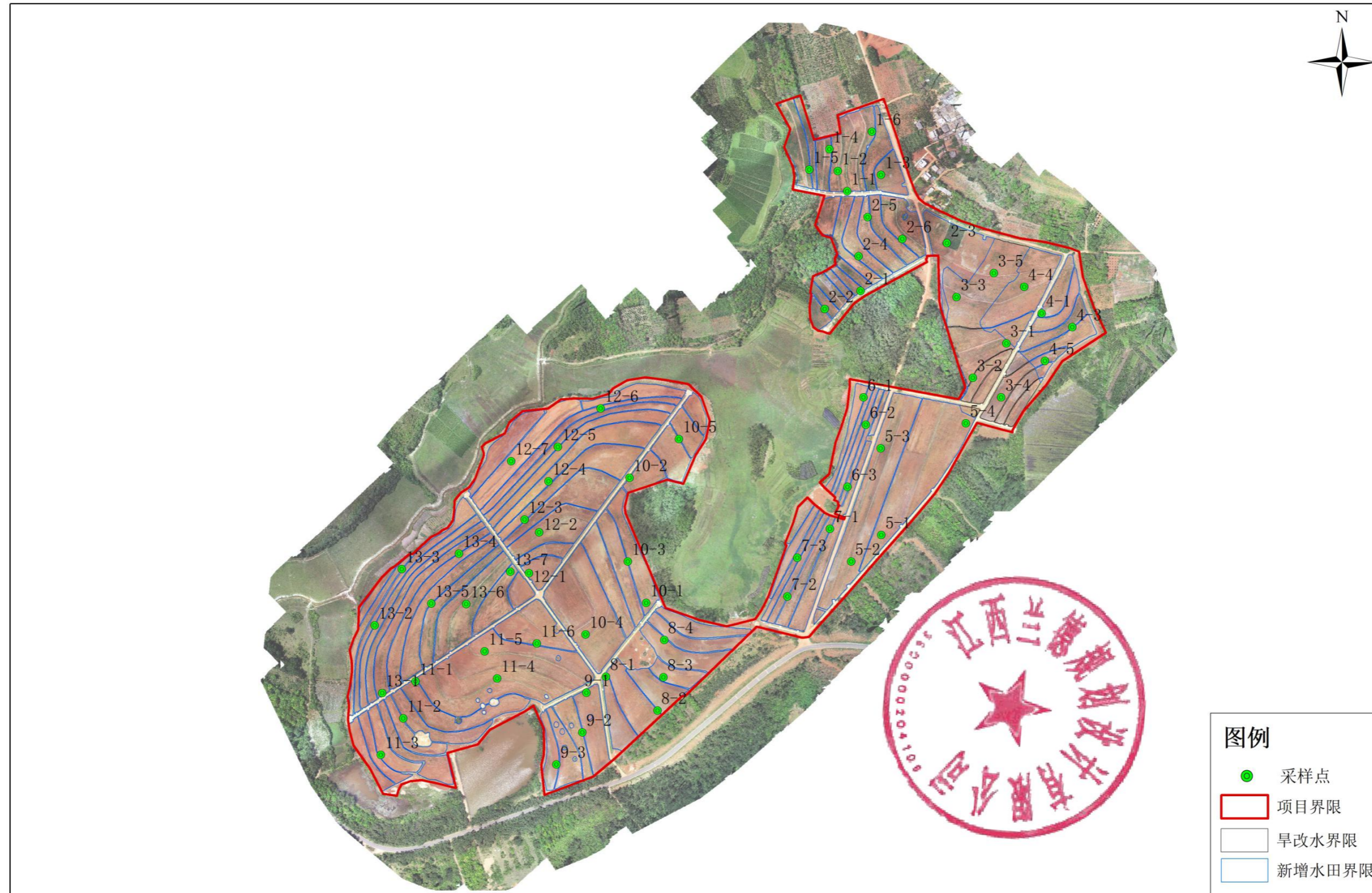
海口市琼山区三门坡镇铁炉土地整治项目土壤样品采集位置示意图
